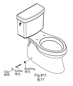
小心的将螺丝旋入支架中直到座便器完 全固定。左右交替旋紧以免座便器偏离 中心。安装螺帽。
