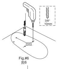
用10mm的钻头在地面上钻孔,然后插入螺栓套管。
