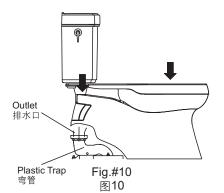
小心对准并将座便器向下放置。同时将座便器边缘向下压,以使排水口插入弯管中。为了要达到最佳的效果,请在安装时确定座便器是否水平。
