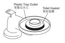
将密封垫圈紧套于弯管出水口。
