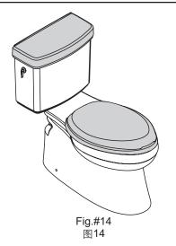
安装水箱盖和盖板。使用附带的盖板安 装组件包进行安装。安装后定期检查漏 水情况。
