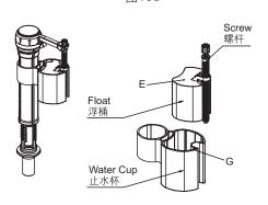
Fig.#16e 图16e 浮桶调节注意事项:调节螺杆时保证 E面下沉于G面2-4mm。
